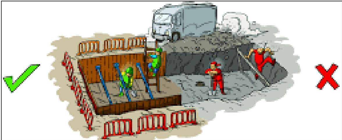
Gambar 22. Ilustrasi pekerjaan tanah
