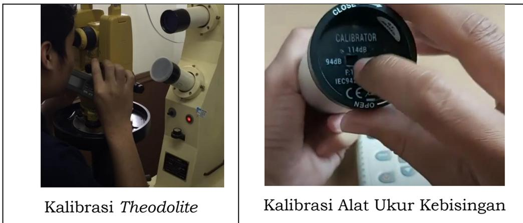
Gambar 3. Contoh kalibrasi alat ukur
